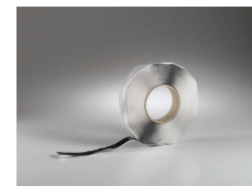
Butyl-Dichtband als Alternative zu Bitumen Dicht- und Klebstoff Zum Verkleben von PE-Folie als Feuchtigkeitssperre, Breite 20mm, Länge 15m, Ø-Verbrauch: 1 Rolle/50m 2 Art. Nr.- 903202
